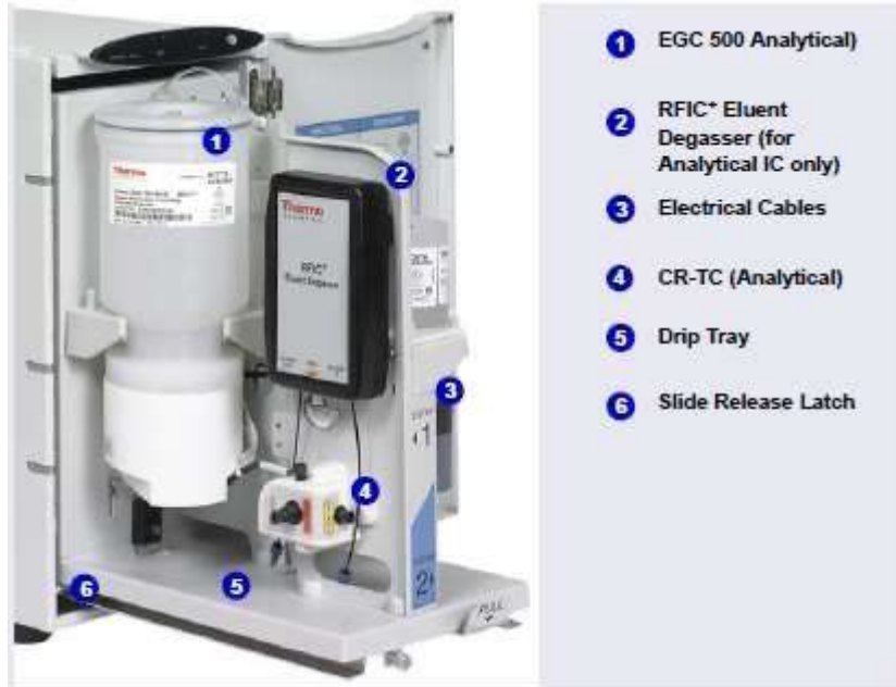
รูปที่ 2-11 แสดงรูปส่วนประกอบด้านในของเครื่อง EG สำหรับ Analytical IC (High Pressure)
