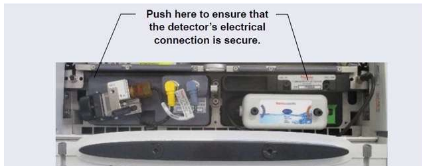
รูปที่ 9-1 แสดงการต่อ Detector
