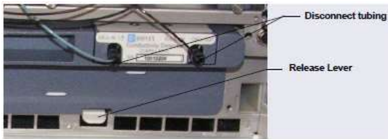
รูปที่ 10-58 การถอดสายจาก CD
