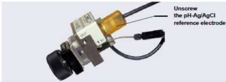
รูปที่ 10-63 แสดงการถอด pH-Ag/AgCl Reference Electrode
