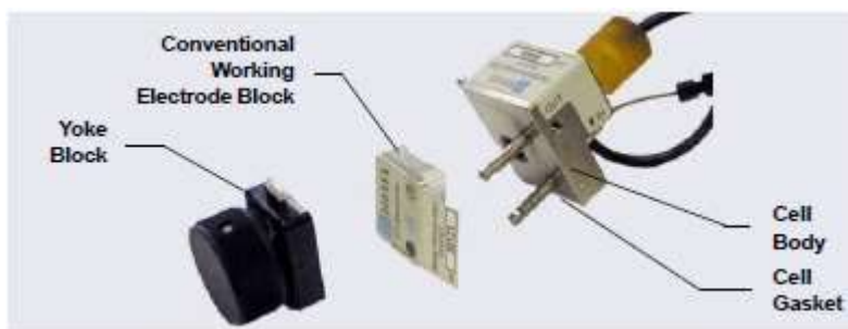
รูปที่ 10-61 แสดงส่วนประกอบต่างๆ ของ cell body
