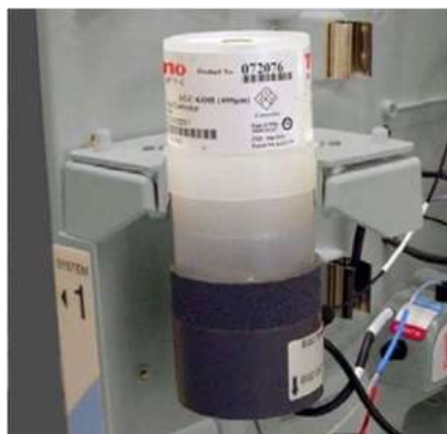
รูปที่ 10-20. Capillary Dionex EGC Installed on Holder
