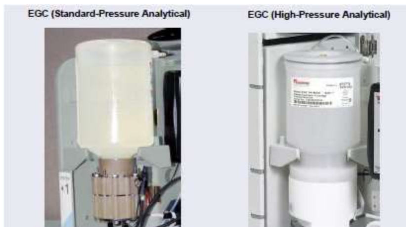
รูปที่ 10-26 Analytical Dionex EGC Installed in Holder
