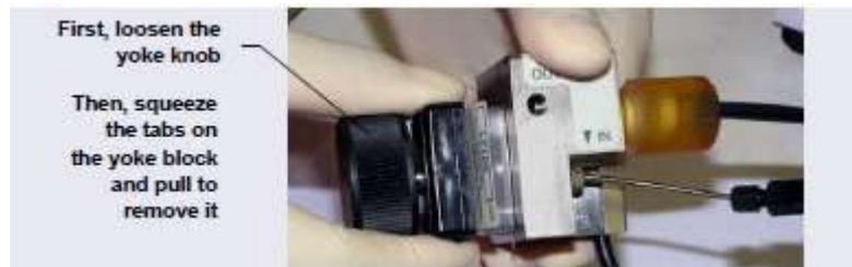
รูปที่ 10-60 แสดงการถอด ED Cell
