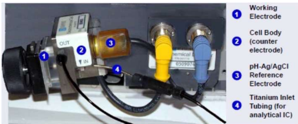
รูปที่ 2-31 แสดง ED Cell กับ pH-Ag/AgCl Reference Electrode
