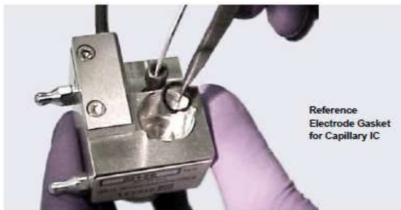
รูป 10-65 แสดงการใส่ Reference electrode gasket ของ pH-Ag/AgCl Reference Electrode
