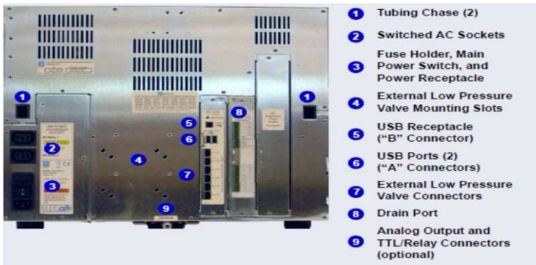
รูป 2-32 แสดงแผงด้านหลังของเครื่อง DC
