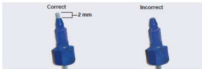
รูปที่ 9-1 การต่อ ferrule และ fitting (High-Pressure Fitting and Ferrule Shown)
