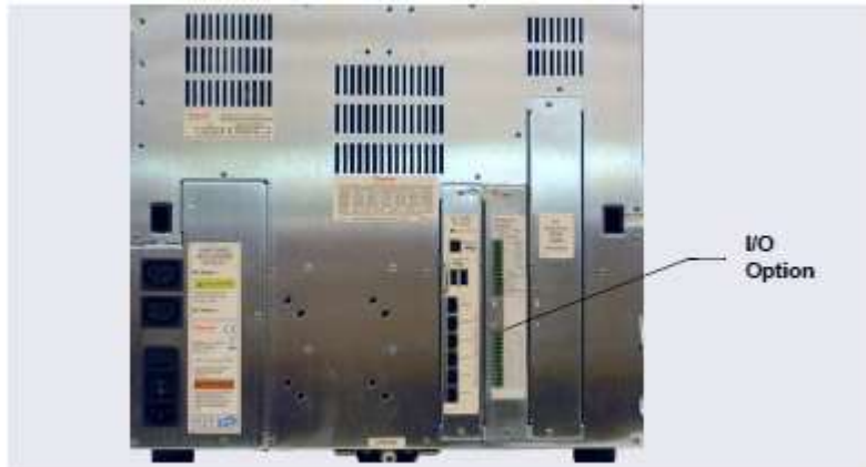
รูปที่ 10-40 แสดงด้านหลังเครื่อง DC: บริเวณที่ติดตั้ง I/O option board
