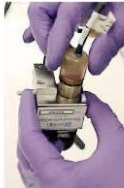
รูปที่ 10-67 แสดงการไล่ pH-Ag/AgCl Reference Electrode
