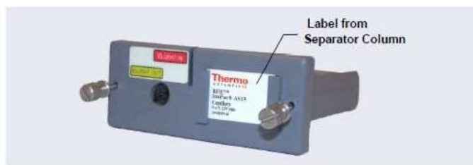
รูปที่ 10-50 แสดงการติดป้าย column ที่ column tray
