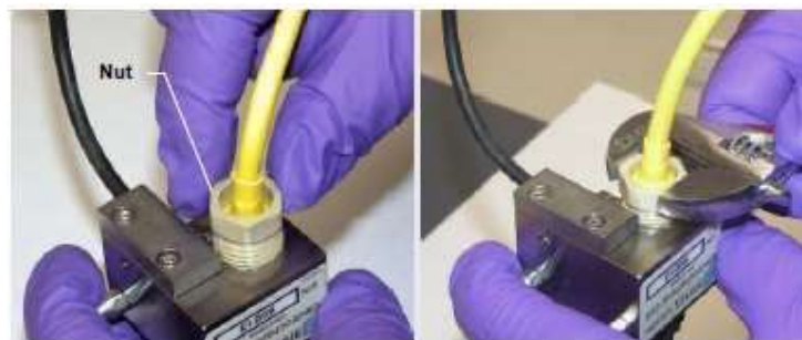
รูปที่ 10-76 การใส่ PdH Reference Electrode Fitting
