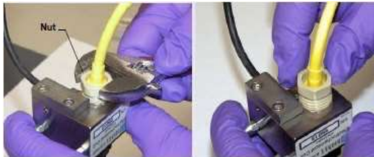
รูปที่ 10-71 การถอด PdH reference electrode nut
