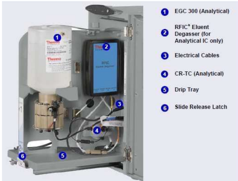
รูปที่ 2-10 แสดงรูปส่วนประกอบด้านในของเครื่อง EG สำหรับ Analytical IC
