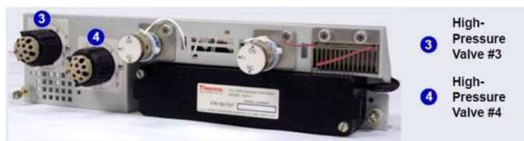
รูปที่ 9-7 High-Pressure Valves #3 and #4 (On AM)
