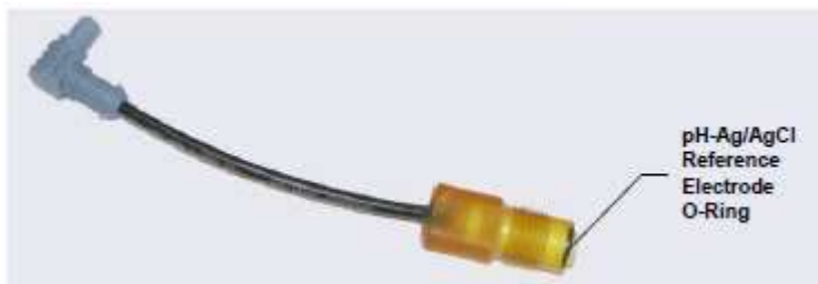
รูปที่ 10-70 แสดงการถอด O-Ring ของ pH-Ag/AgCl
