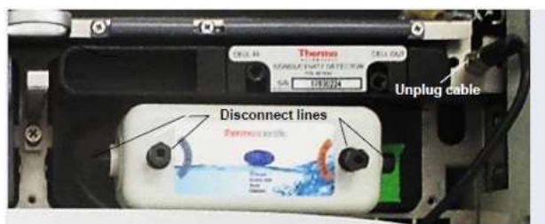
รูปที่ 10-57 แสดงการถอด Suppressor
