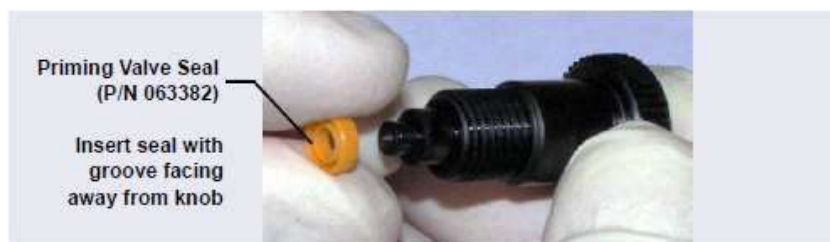
รูปที่ 10-13 การเปลี่ยน Priming Valve Seal
