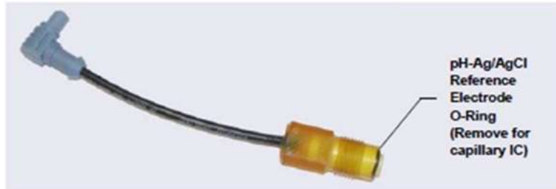
รูปที่ 10-68 แสดง O-ring ของ pH-Ag/AgCl Reference Electrode
