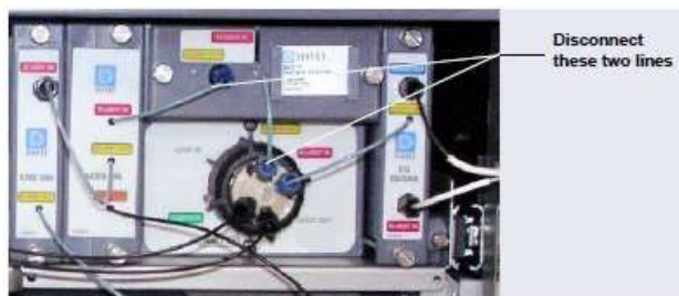
รูปที่ 10-48 แสดงการถอดสาย Capillary Cartridge Eluent Lines
