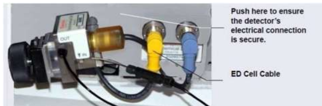
รูปที่ 9-4 การต่อ Electrochemical Detector (Analytical Cell Shown)
