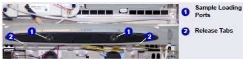
รูปที่ 10-33 แสดง Sample Loading Port และ Release Tabs
