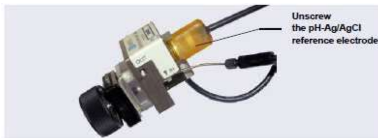
รูปที่ 10-69 แสดงการถอด pH-Ag/AgCl Reference Electrode
