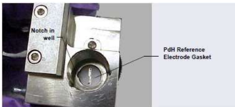
รูปที่ 10-73 การถอด PdH reference electrode gasket
