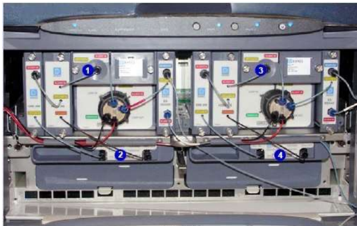
รูปที่ 2-18 แสดงภาพส่วนด้านบนของ DC ที่เป็น Dual Capillary IC
