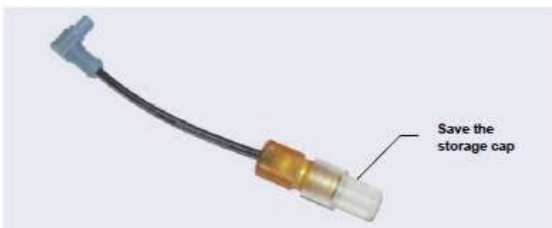
รูปที่ 10-64 แสดง pH-Ag/AgCl Reference Electrode ในอุปกรณ์ที่ใช้เก็บ
